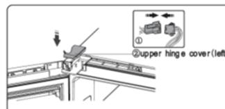
17. Поверните часть (1) на 180° и установите на правый край верхней двери, затем установите часть (2) (обе части были ранее отсоединены согласно пункту № 2).
