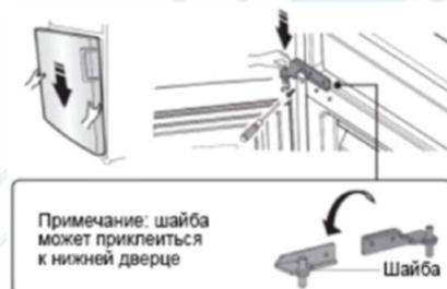
13. Открутите верхнюю шарнирную ось, переверните верхнюю петлю/шарнир и зафиксируйте ось на нем. Затем отложите в сторону, они нам понадобятся позже.
