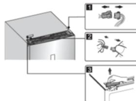
4. Открутите гайки (1), отсоедините провод (2) и снимите часть (3).
