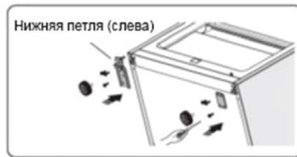
12. Приложите нижнюю дверь и выровняйте таким образом, чтобы совпали оси петель/шарниров. Поверните среднюю петлю/шарнир на 180°, переместите гайку/шайбу на верхнюю часть, отрегулируйте среднюю петлю/шарнир на соответствующее место и затем установите.
