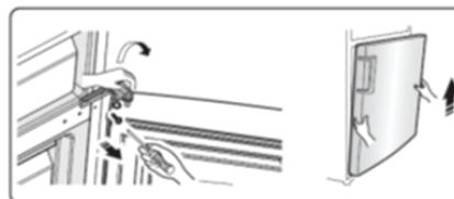
7. Поместите нижнюю дверь на мягкую поверхность фронтальной панелью вверху. Переместите ручку на правую сторону как описано в пункте № 5. Открутите болты/гайки (7), отсоедините части (6) и (5), переверните часть (5) на 180° и установите части (5) и (6) на соответствующие места слева с помощью винтов (7).
