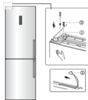
16. Подсоедините электрический коннектор (1) в соответствии с пунктом № 3, а затем установите часть (2) (она в находится в пластиковом пакете).
