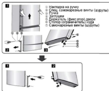
6. Открутите болты, фиксирующие среднюю петлю/шарнир и снять петлю/шарнир. Затем снимите нижнюю дверь.
